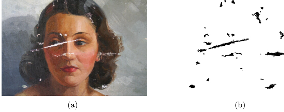
Figura 2.1: Imagens de entrada dos algoritmos de retoque digital: (a) Imagem corrompida (as regiões deterioradas correspondem ao domínio de retoque); (b) Máscara (as áreas em preto correspondem ao domínio de retoque da imagem original).
