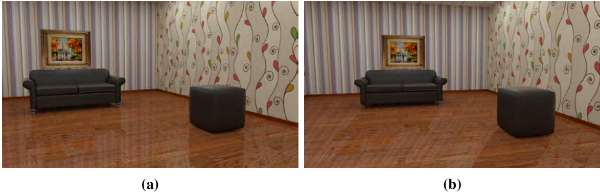
Figura 8-1: Renderização de duas vistas utilizando reflexão pré-calculada na origem do POMC . (a) Os reflexos são corretos pois a câmera está posicionada na origem do POMC . (b) A câmera deslocada da origem do POMC causa distorções visíveis quando é realizado um mapeamento com reflexões pré-calculadas (e.g., as paredes refletidas no piso da sala).
