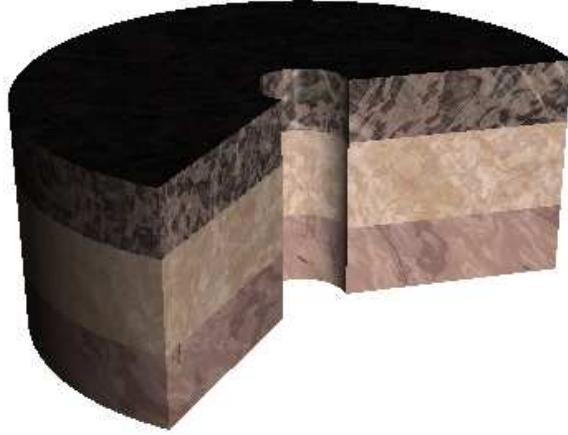
Figura 3.2: Representação do meio poroso estratificado na geometria 3D axisimétrica. O poço de injeção, no centro, é representado pelo furo, que é perpendicular à estratificação
