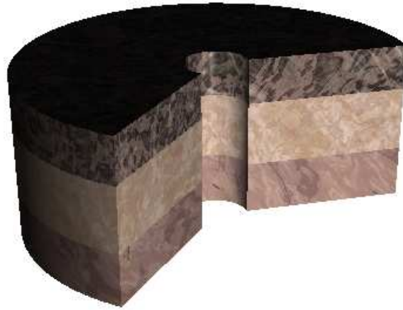
Figura 4.13: Reservatório na geometria 3D axissimétrica
