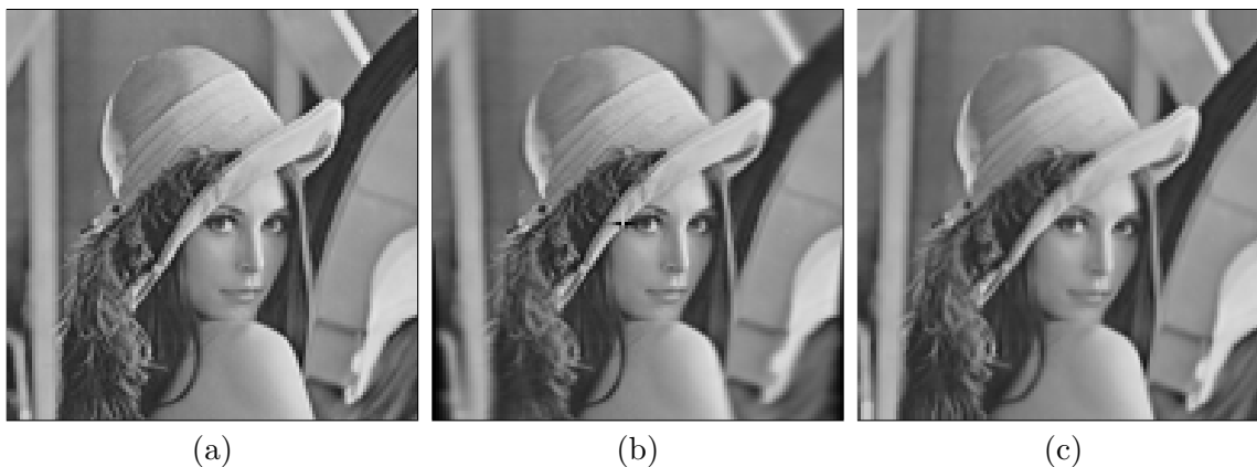
Figura 5.12: Sequência de Rotação Planar Virtual 1. (a) Primeiro quadro. (b) Quadro intermediário gerado por filtro de Green de 2ª ordem, com os parâmetros (A_0, A_1, A_2, x_U) = (3, 0.000848, -0.049384, 59) e (B_0, B_1, B_2, y_V) = (3, -0.047969, -0.002005, 61) . (c) Terceiro quadro gerado por warping, com parâmetros (a_0, a_1, a_2, b_0, b_1, b_2) = (3, 0, -0.05, 3, -0.05, 0) .
