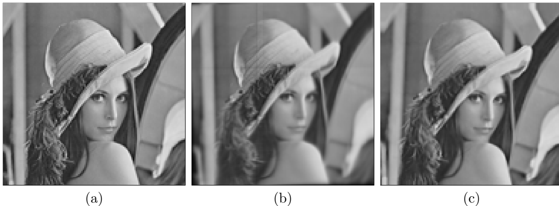
Figura 5.13: Sequência de Rotação Planar Virtual 3. (a) Primeiro quadro. (b) Quadro intermediário gerado por filtro de Green de 1 a ordem adaptado, com os parâmetros (A_0, A_2) = (3, -0.012) , na direção horizontal, e (B_0, B_1) = (3, -0.012) , na direção vertical. (c) Terceiro quadro gerado por warping, criado como na sequência de rotação planar virtual 1.
