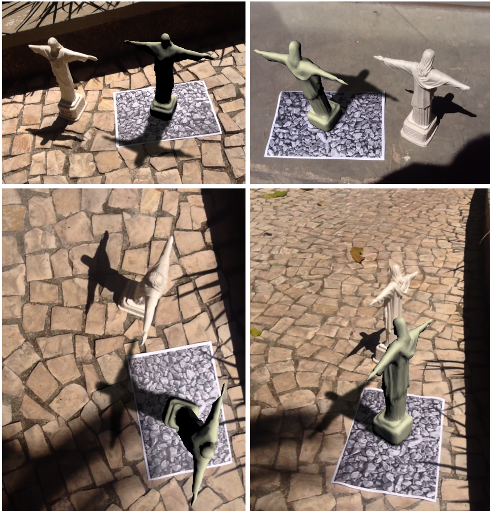
Figura 4.4: Comparando, de vários ângulos, modelo virtual e real numa cena externa com o iPad 2. A suavidade da sombra depende do blur aplicado. Nesse experimento, aplicamos um filtro gaussiano de tamanho 7 \times 7 e utilizamos um shadow map de 1024 \times 1024 pixels.
