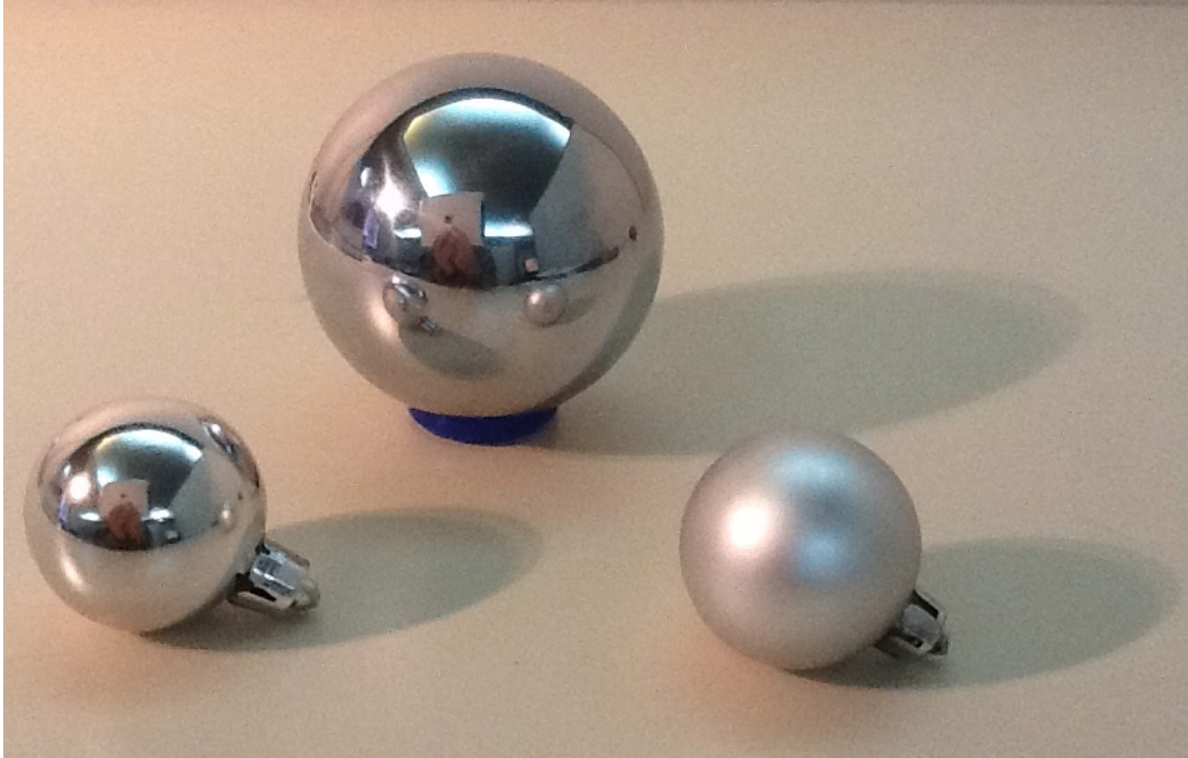
Figura 2.3: Foram utilizadas esferas espelhadas, esferas difusas e de tamanhos distintos nos experimentos. As pequenas são simplesmente bolas de natal.
