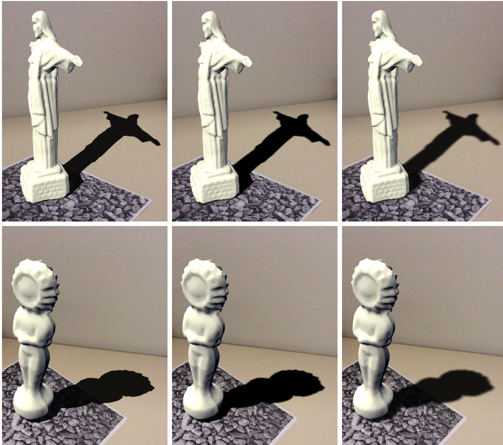
Figura 4.6: Comparando os três métodos de síntese de sombras descritos: shadow mapping , percentage closer filtering e variance shadow mapping . Nessa comparação, utilizamos no percentage closer filtering um blur de janela 8 \times 8 para mostrar sua eficácia na suavização da sombra e, como esperado, o desempenho foi comprometido. Os demais métodos, shadow mapping e variance shadow mapping foram executados em tempo real.
